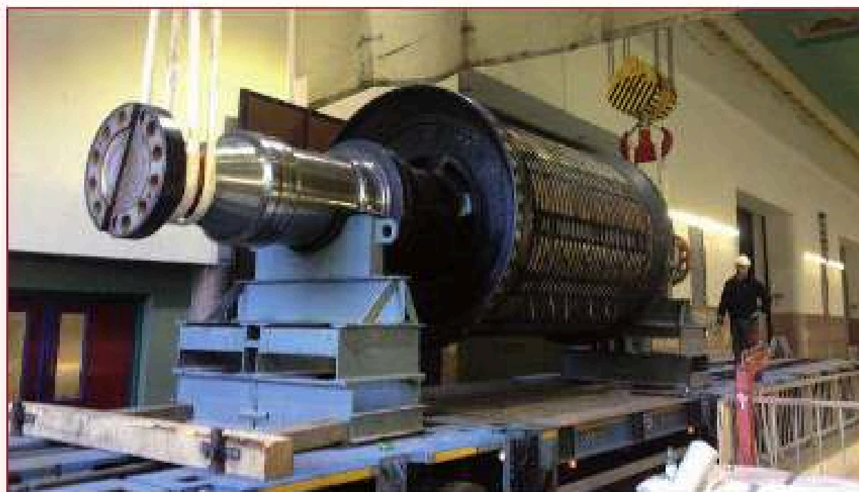
(Bild links) Obere Statorhälfte von Generator 3 wird ausgehoben (Bild oben) Der alte Läufer ohne Pole wird abtransportiert
